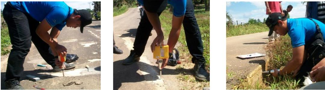
Gambar 4. Pengujian menggunakan Hammer Model N/NR
