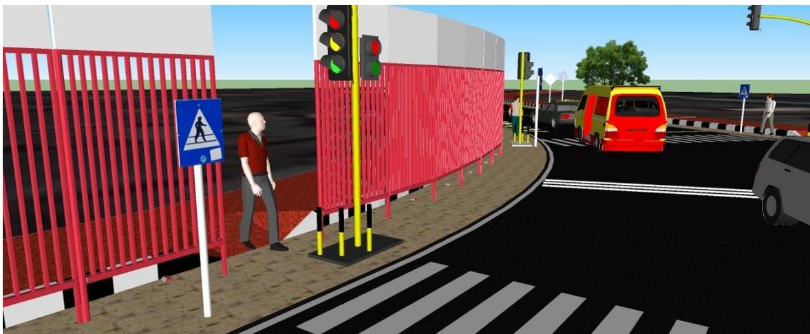
**Gambar 5** Disain pemasangan pagar pengaman (*barrier*) di sepanjang bahu jalan sebelah kananarah utara hingga selatan.
