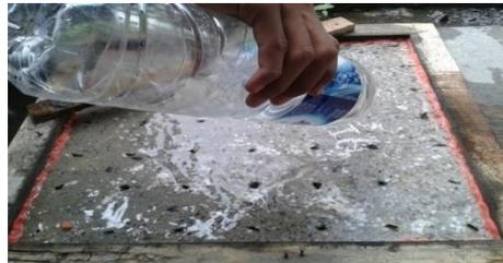
**Gambar 3.** Pengujian Permeabilitas
