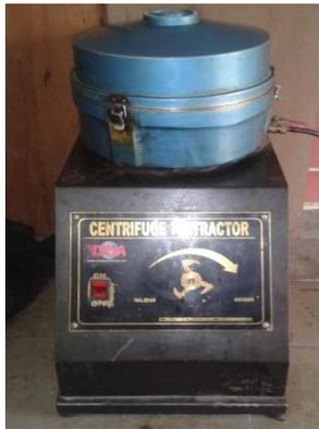
**Gambar 1** Alat Uji Ekstraksi Sentrifugal
