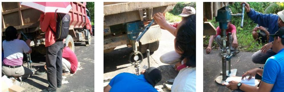
Gambar 6. Pengujian CBR<sub>Lapangan</sub>
