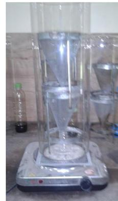
**Gambar 2** Alat Uji Ekstraksi Refluk
