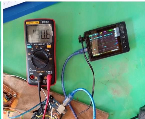
Pengukuran Tegangan Delay 2 ms
