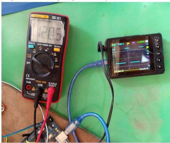
Pengukuran Tegangan Delay 7 ms
