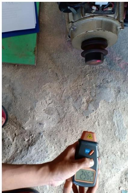
Pengukuran RPM Delay 3 ms
