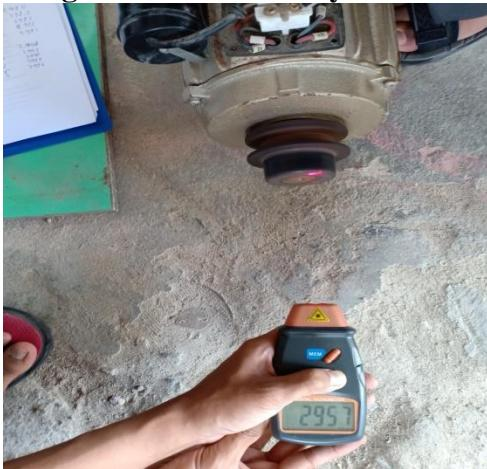
Pengukuran RPM Delay 6 ms
