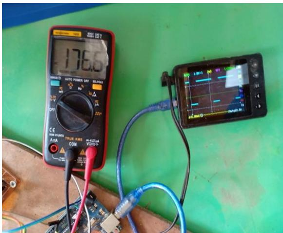
Pengukuran Tegangan Delay 3 ms
