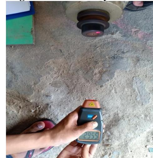
Pengukuran RPM Delay 5 ms
