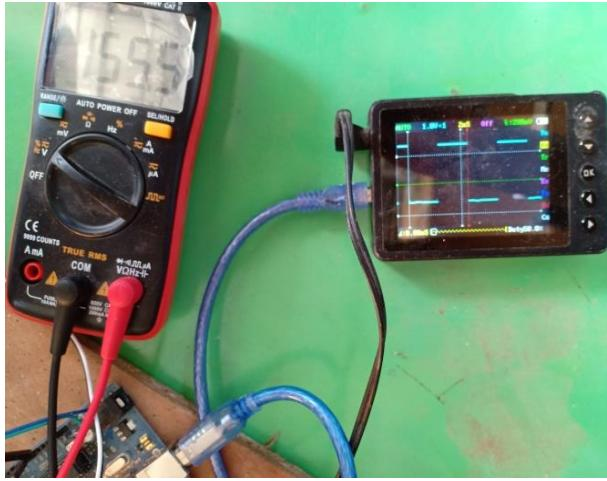
Pengukuran Tegangan Delay 5 ms
