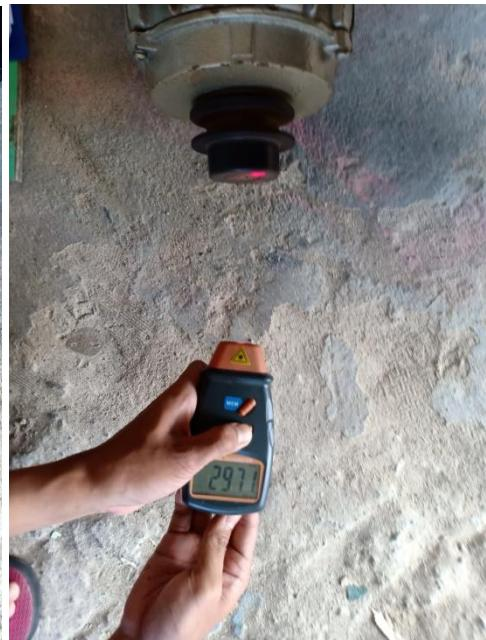
Pengukuran RPM Delay 2 ms
