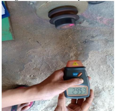
Pengukuran RPM Delay 7 ms
