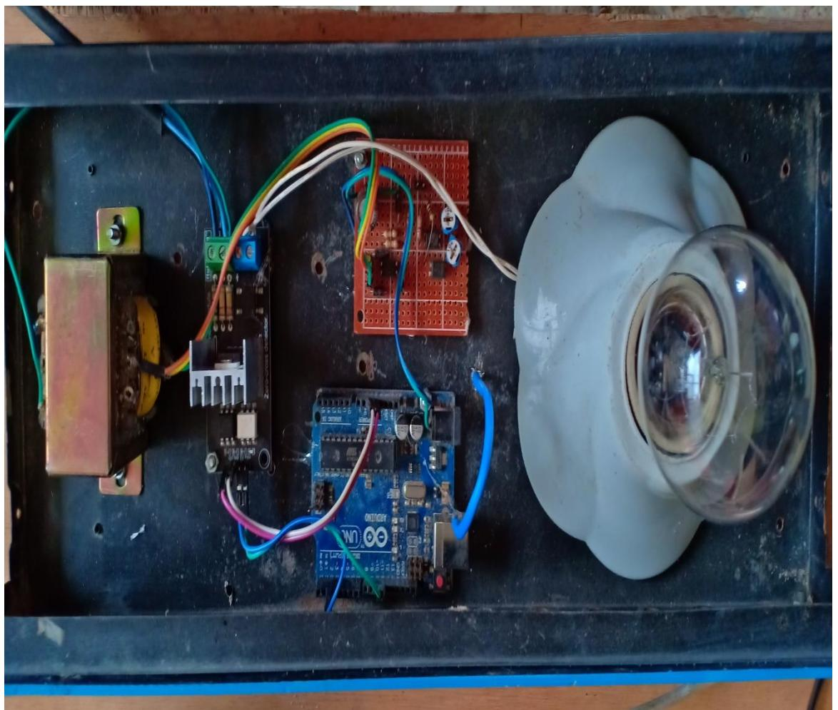
**Gambar Alat Berupa Rangkaian *Soft Starter* Menggunakan Arduino**
