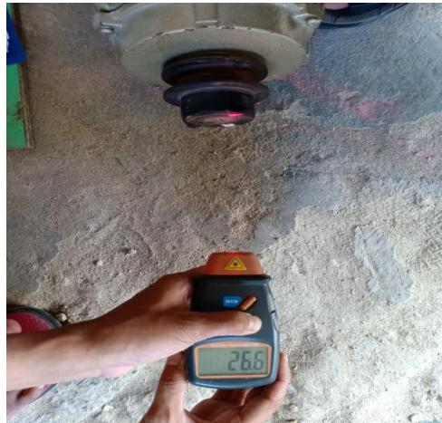
Pengukuran RPM Delay 9 ms
