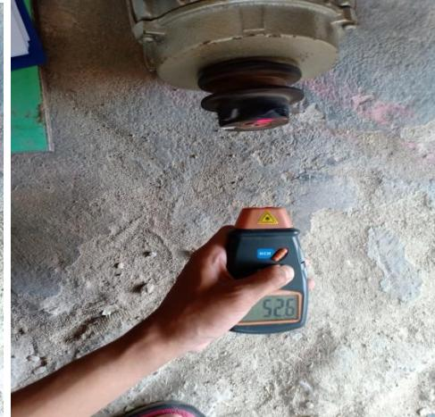
Pengukuran RPM Delay 8 ms
