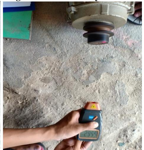
Pengukuran RPM Delay 4 ms
