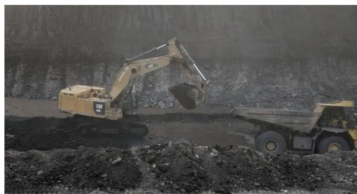
Gambar 4.5. Kondisi aktual *fleet* pengupasan *overburden*
