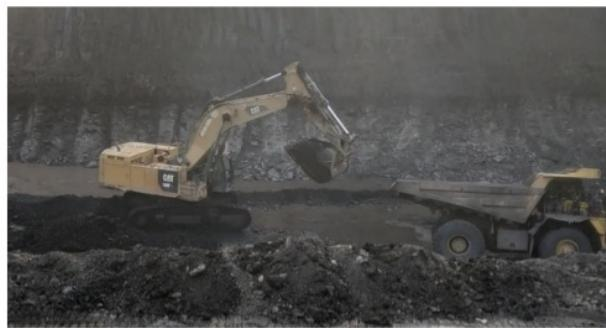
Gambar 4.5. Kondisi aktual *fleet* pengupasan *overburden*
