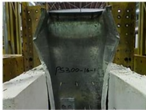
(d) CFS buckling
