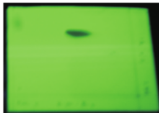
GAMBAR 4: Hasil uji KLT dua dimensi terhadap kristal Fe dengan eluen etilasetat metanol 8:2 dan etilasetat aseton 9:1 dengan penampak noda lampu UV
