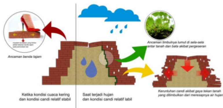
Gambar 10: Analisis penyebab kerusakan pada candi batubata
