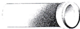
Gambar 1. Disain Pipa Gerabah dengan panjang 30cm, diameter dalam pipa 10cm dengan ketebalan 2cm.
