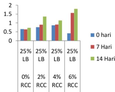
**Gambar 6** Diagram Nilai CBR dengan campuran *Residium Catalytic Cracking* 2%, 4%, 6% dan Limbah Pabrik Batu tiap variasi 25%.
