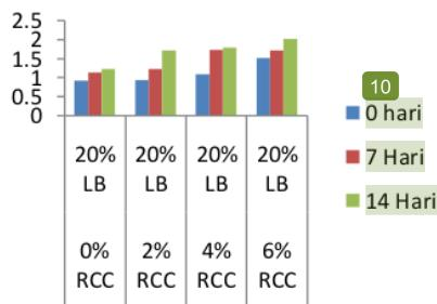
**Gambar 5** Diagram Nilai CBR dengan campuran *Residium Catalytic Cracking* 2%, 4%, 6% dan Limbah Pabrik Batu 20%.
