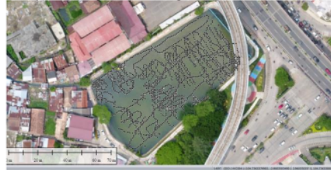
Gambar 9. Kerangka Arsiran Boat/Robot Kearah Horizontal dan Vertikal
