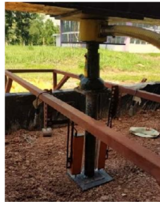
Gambar 2 Foto penempatan alat dan pondasi pada tanah dalam bak uji
