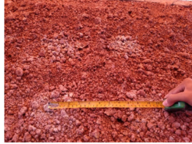
Gambar 4. Foto tampak atas kolom tanah yang telah tertanam dalam tanah lempung
