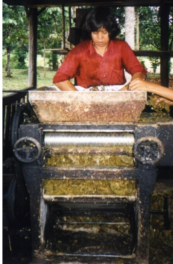
Gambar 4.5. Penggilingan daun gambir pascaperebusan dalam keadaan hangat
