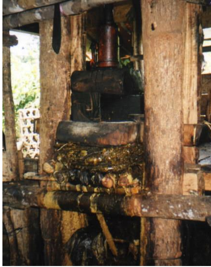
Gambar 4.6. Pengepresan sari daun gambir dengan alat hidrolik berkekuatan 3 ton
