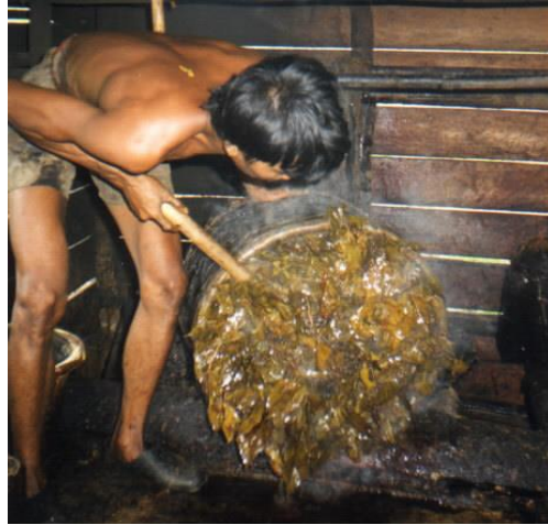
Gambar 4.4. Pembongkaran daun gambir pascaperebusan dalam keadaan panas.
