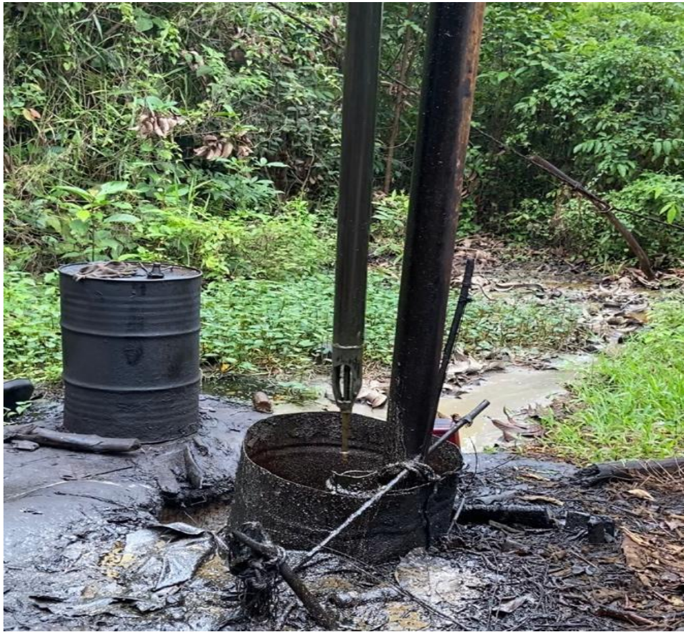
Alat Tradisional Yang Di Gunakan Untuk Mengebor Minyak
