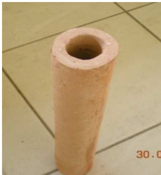
Gambar 4. 2. Tipikal membran (filter) keramik
