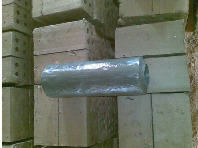
Gambar 2.3. Membran terbuat dari zeolit, pasir silika dan mangan
