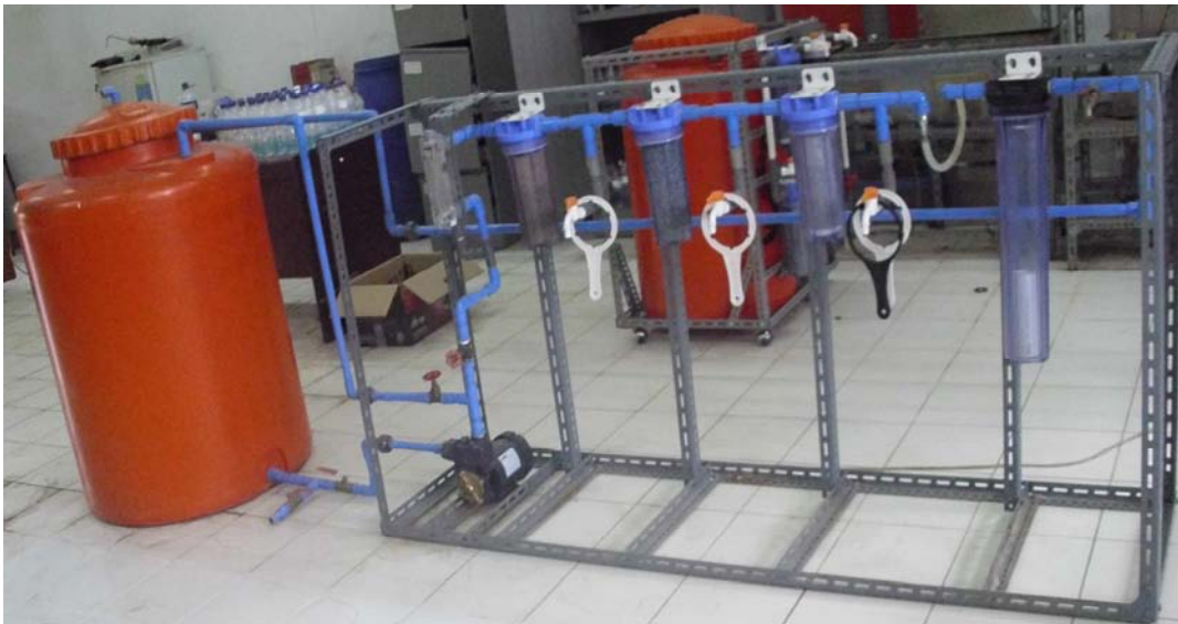
Gambar 4.1. Sistem Pengolahan Limbah Cair dengan menggunakan filtrasi membran keramik
