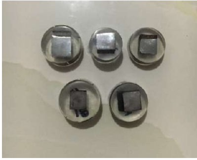
Spesimen Struktur Mikro As Receive dan Setelah Perlakuan Panas
