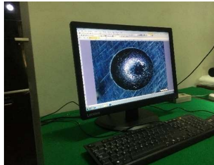
Pembacaan Hasil Injakan Uji Kekerasan
