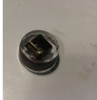
Spesimen Struktur Mikro As Receive dan Setelah Perlakuan Panas
