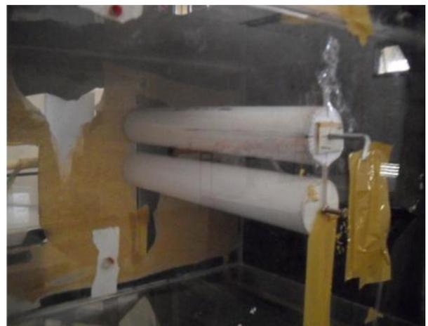
**Gambar 3.** Selinder di dalam Wind Tunnel
