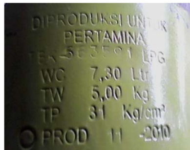
Gambar 1.Spesifikasi Tabung Gas LPG 3 kg [3]
