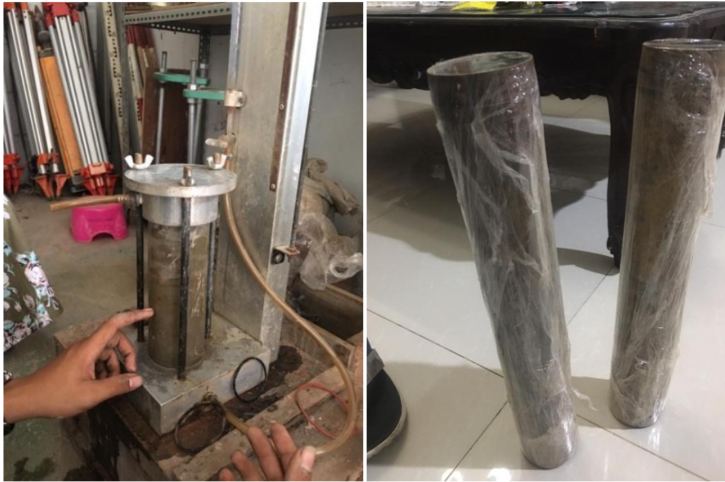
Gambar 4.5.. Pengujian Falling Head Untuk Mengetahui Nilai Koefisien Permeabilitas Tanah Asli
