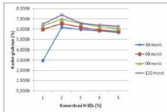
**Gambar 1.** Kadar Glukosa Setelah Proses Hidrolisis dengan H<sub>2</sub>SO<sub>4</sub> pada Berbagai Variasi Konsentrasi dan Waktu Hidrolisis
