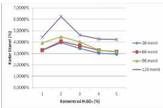
**Gambar 2.** Kadar Etanol Setelah Proses Hidrolisis Menggunakan H<sub>2</sub>SO<sub>4</sub> pada Beberapa Variasi Konsentrasi dan Waktu Hidrolisis
