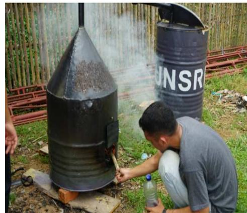
Gambar 4 Uji Coba Alat Pirolisis
