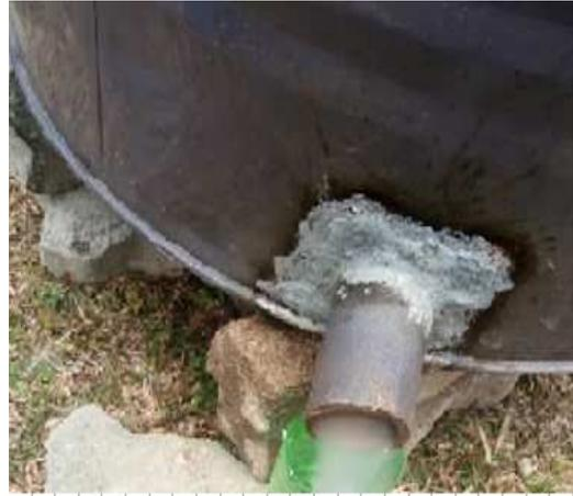
Gambar 2 Nozzle Asap Cair Pada Kondensor
