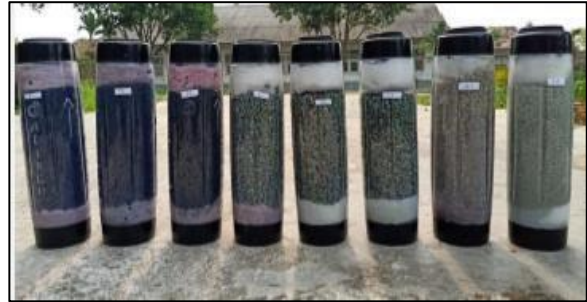
Gambar 2 Kolom adsorpsi yang berisi adsorben
