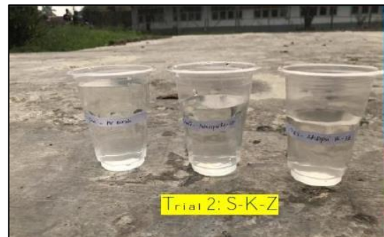
Gambar 4 Hasil trial kedua (susunan adsorben pasir silika-karbon aktif-zeolit)
