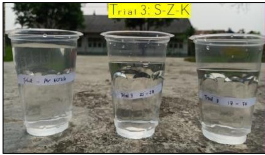
Gambar 5 Hasil trial ketiga (susunan adsorben pasir silika-zeolit-karbon aktif)
