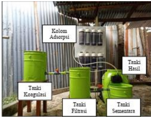
Gambar 1 Rangkaian alat pengolahan limbah cair secara bertingkat
