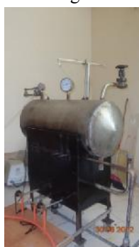
Gambar 9. Hasil perancangan Mini Boiler
