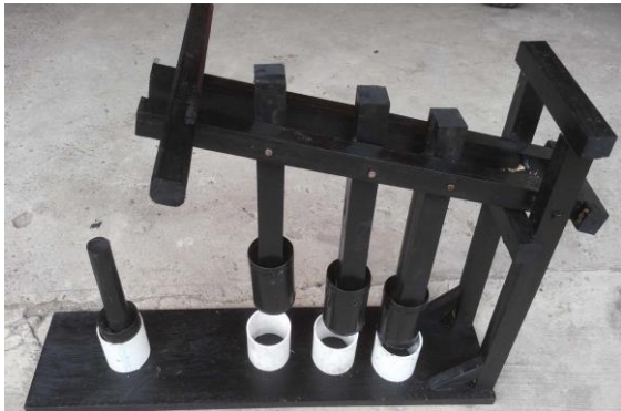
Gambar 2 Alat pres bio briket sederhana
