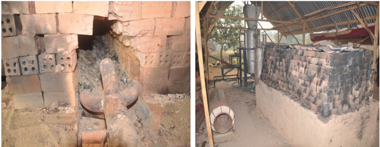
Gambar 5 Bentuk lorong api lurus dan hasil pembakaran batubata merah
