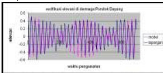
Gbr 1. Verifikasi antara hasil pengukuran dengan hasil model simulasi hidrodinamika di Dermaga Pondok Dayung, Tanjung Priok Jakarta.
