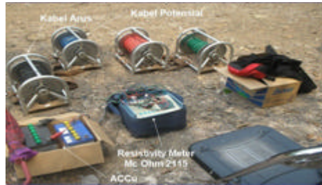
Gambar 2. Perangkat pengukuran geolistrik McOhm 2115 Buatan OYO
