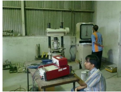
Gambar 4. Uji Tekan Silinder Beton, (Sumber: Puslitbang Permukiman, 2010)
