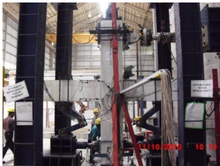
Gambar 5. Pengujian Beban Aksial Konstan dan Siklik Statik Monotonik pada Sistem Struktur Beton Pracetak Join Balok-Kolom (Sumber: Puslitbang Permukiman, 2010)
