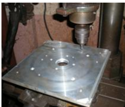
Gambar 8. (a)Proses pengeboran (b)proses pengetapan
