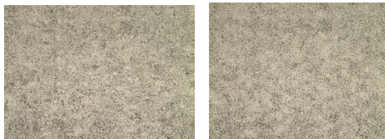
Gambar 9. Struktur Mikro Spesimen Sesudah Mengalami 4 dan 6 Kali Lalan (Pembesaran 180 x)
