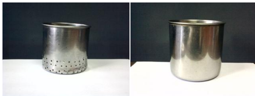
Gambar 4. Tabung Ekstraksi dan Penampung Minyak
