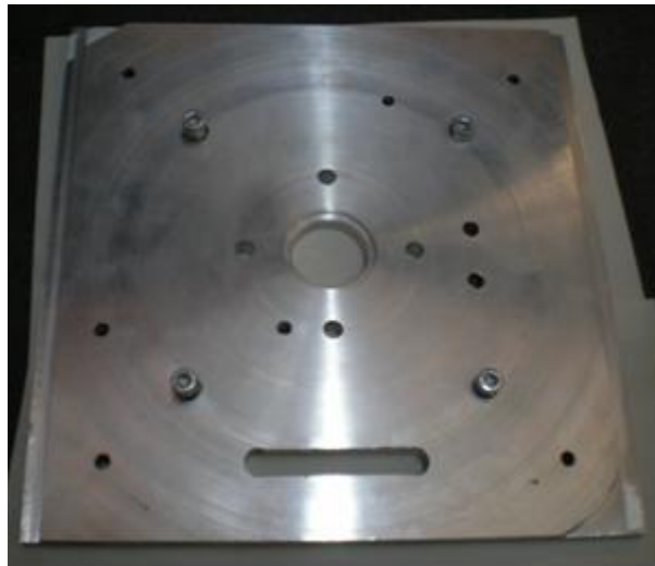
Gambar 12. Alat Bantu terpasang di meja CMM
