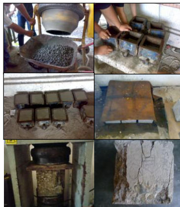
Gambar 3. Pembuatan, perawatan dan pengujian benda uji
