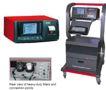
Gambar 3.3 Peralatan pengambilan dan penganalisis sampel emisi gas buang
