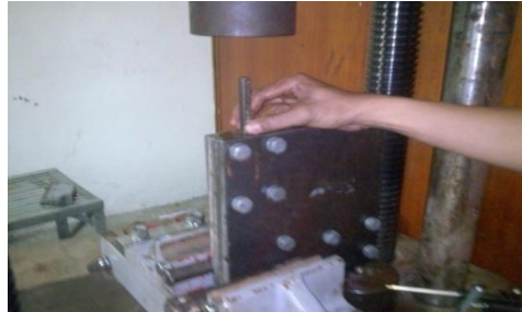
Gambar 5. Alat ECAP Yang Dikombinasikan Dengan Universal Testing Machine
