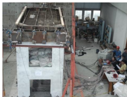
Gambar 8. Pengujian Sistem Struktur Dinding Beton Pracetak Tampak Samping (Sumber: Puslitbang Permukiman, 2010)
