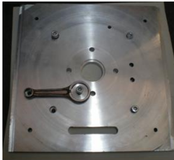
Gambar 13. Alat bantu terpasang di meja CMM dilengkapi dengan connecting rod
