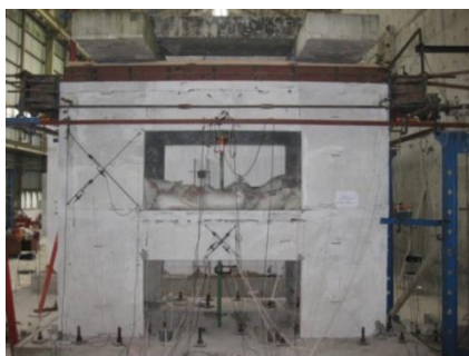
Gambar 7. Pengujian Sistem Struktur Dinding Beton Pracetak Tampak Depan (Sumber: Puslitbang Permukiman, 2010)
