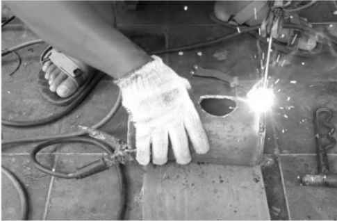
Gambar 4. Pengelasan bagian-bagian kompor oli bekas
