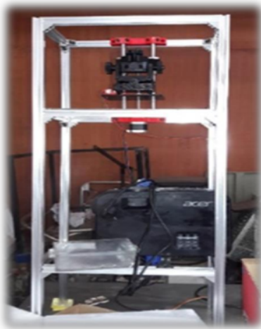
Gambar 4 Hasil produksi mesin cetak 3D tipe DLP
