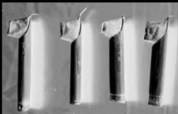
Gambar 29. Canting Tulis Tembaga Bergagang Bambu dengan Berbagai Ukuran (03.3254)
