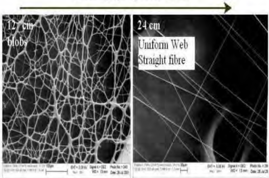
Figure 3.2: Efek dari meningkatnya jarak layar kapiler pada 20-wt.% Estane elektrosinning at 10 kV and 3 ml/h, diameter rata-rata berkisar 5 \mu\text{m} – 333 \mu\text{m} . rata-rata diameter dari serat dan ukuran butir menurun dengan peningkatan jarak layar kapiler (Wilkes, 2009).
