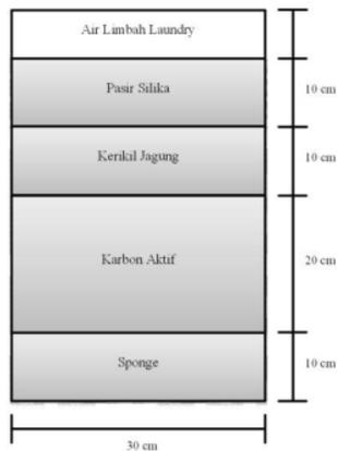
Gambar 1. Rangkaian Penyaringan
