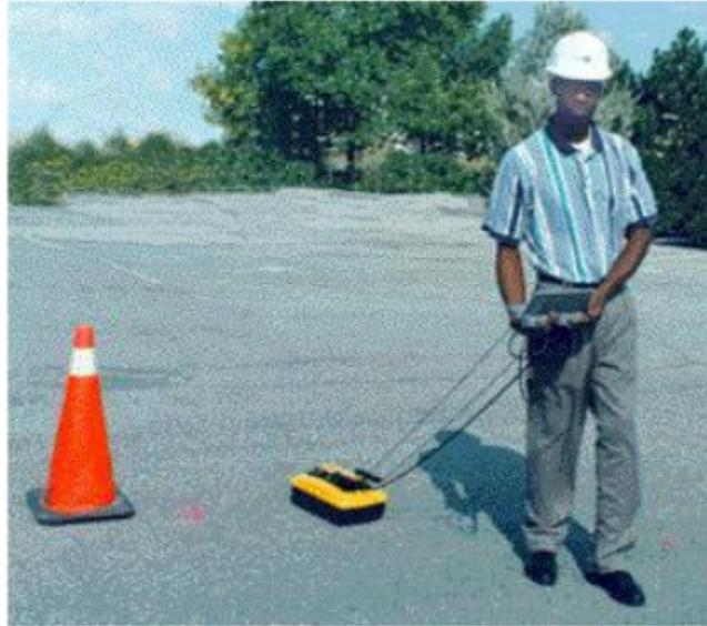
Gambar 2-18. Penggunaan Sistem GPR. Sistem yang ditunjukkan di sini adalah sistem Noggin 500, yang beroperasi pada kisaran 250 - 750 MHz, dan dirancang untuk pencitraan dengan resolusi tinggi dari permukaan bawah dangkal (sampai 8 meter, tergantung pada bahan). Sistem ini diproduksi oleh Sensors & Software, Inc. dari Mississauga, Kanada. (Gambar milik Sensors & Software, Inc.)
