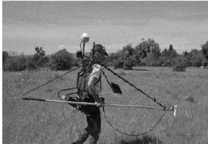
Gambar 2-3. Sebuah magnetometer darat portabel Magnometri 858 Mag Mapper dengan sistem penentuan posisi GPS Trimble terpadu (courtesy of Geometrics).
