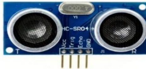
Gambar 2.1 Modul Sensor Ultrasonik HC-SR04 (Magdalena dkk., 2013).
