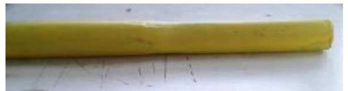
Gambar 4. Nosel Ellips yang diuji
