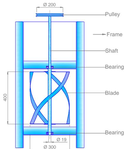
**Gambar 2.1.** Konstruksi Model Turbin Air Sudu Helikal
