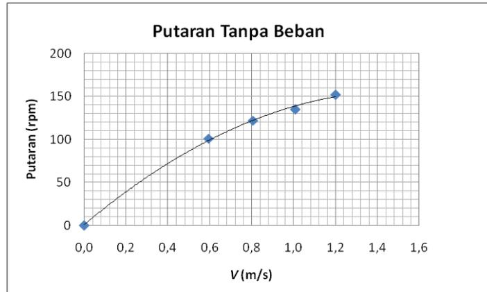
**Gambar 3.1.** Grafik putaran tanpa beban vs kecepatan aliran
