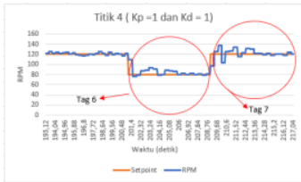
Gambar 18. Grafik Pengujian Kedua di Titik 4 dengan K_p = 1 dan K_d = 1
