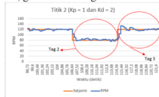
Gambar 9. Grafik Pengujian Pertama di Titik 2 dengan K_p = 1 dan K_d = 2
