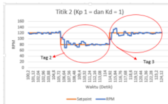
Gambar 10. Grafik Pengujian kedua di Titik 2 dengan K_p = 1 dan K_d = 1
