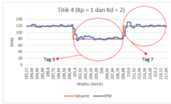
Gambar 17. Grafik Pengujian Pertama di Titik 4 dengan K_p = 1 dan K_d = 2
