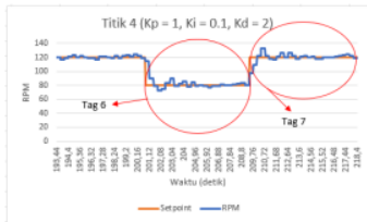
Gambar 20. Grafik Pengujian Keempat di Titik 4 dengan K_p = 1 , K_i = 0.1 dan K_d = 2
