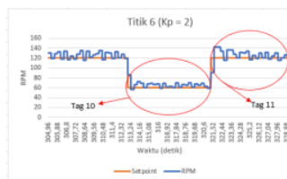
Gambar 27. Grafik Pengujian Ketiga di Titik 6 dengan K_p = 2
