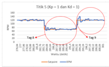
Gambar 22. Grafik Pengujian Kedua di Titik 5 dengan K_p = 1 dan K_d = 1
