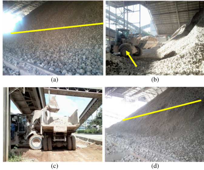
Gambar 8. Langkah-Langkah Penanganan Material Batu Kapur. (a) Produk Besar pada Stockpile Batu Kapur (b) Wheel Loader Hitachi ZW 180 (c) Proses Pemuatan Produk Besar Batu Kapur ke dalam Dump Truck (d) Stockpile Batu Kapur Setelah dipisahkan dari Produk Besar
