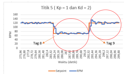
Gambar 21. Grafik Pengujian Pertama di Titik 5 dengan K_p = 1 dan K_d = 2
