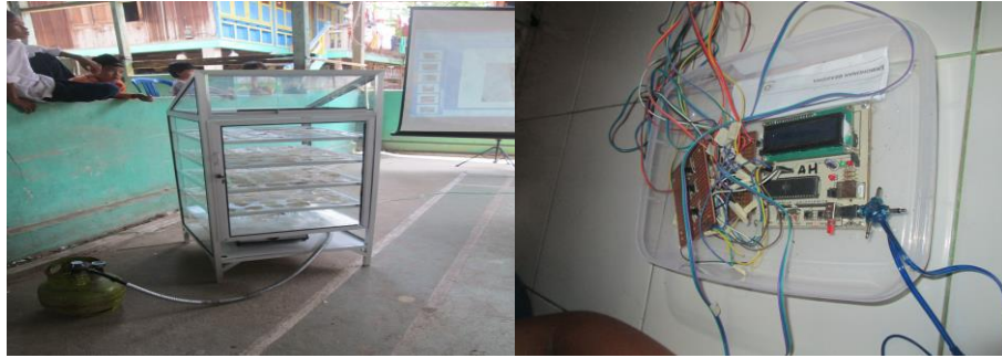
Gambar 3. Alat Pengering energi solar dan elpiji serta alat pengukur suhu otomatis
