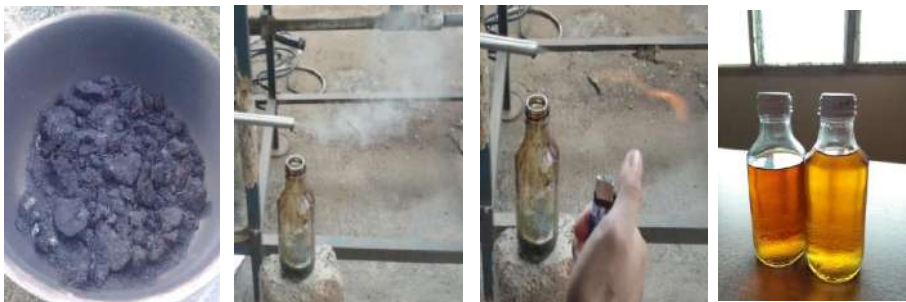
Gambar 6. 6. Hasil konversi limbah kulit durian menjadi produk berupa bio-arang, gas, dan bio-oil.
