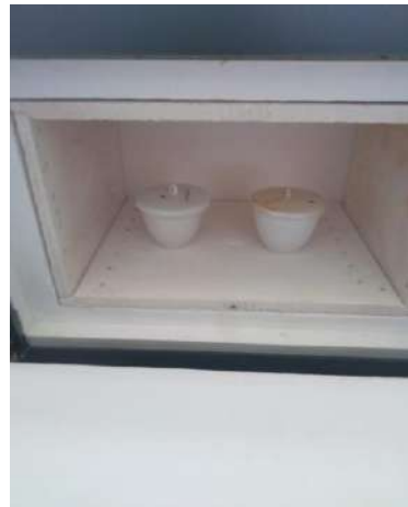
Gambar 7. 6. Kalsinasi Katalis Zeolit dengan Furnace
