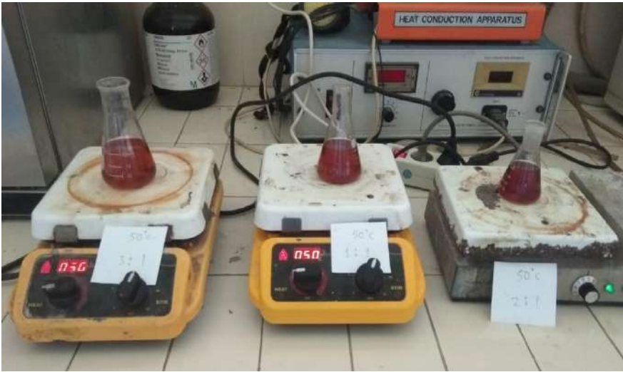
Gambar 6. 12. Proses pemanasan campuran bio-oil dan pelarut metanol pada temperatur 50 °C
