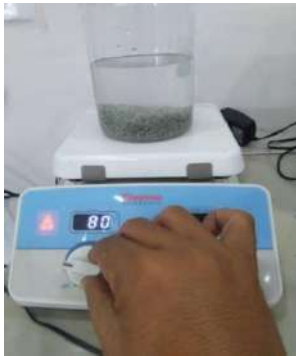
Gambar 7. 5. Presipitasi Zeolit dengan larutan KOH 1 N
