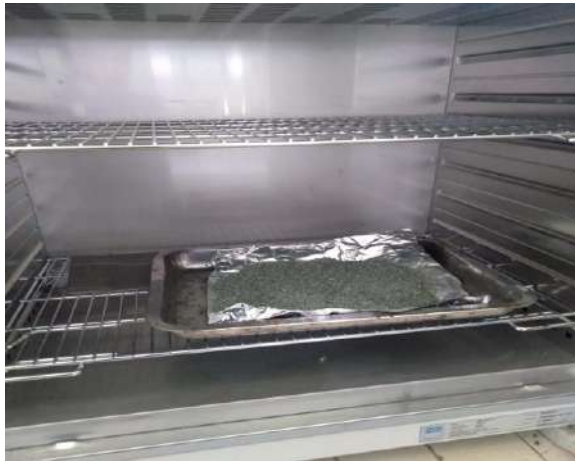
Gambar 7. 4. Pengeringan zeolit dalam oven suhu 110 C
