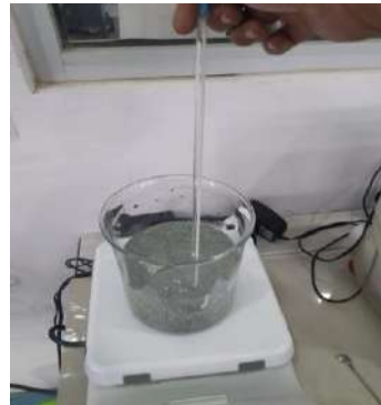
Gambar 7. 5. Presipitasi Zeolit dengan larutan KOH 1 N
