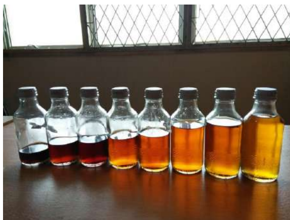
Gambar 6. 10. Hasil Konversi Limbah Kulit Durian Menjadi Bio-oil pada berbagai ukuran dan temperatur reaksi
