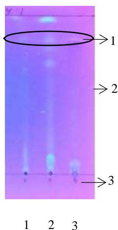
Gambar 3. Hasil KLT dengan eluen n- heksan : etil asetat (4 : 1) divisualisasi dibawah UV 366 nm.
