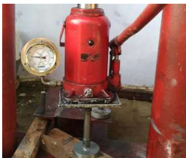
Kompaksi pertama dengan tekanan 1200 psi atau 70 \text{ kg/cm}^2
