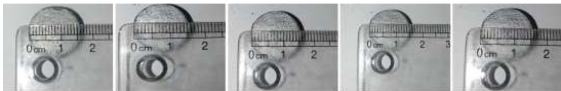
Green body material komposit berpori space holder karet
