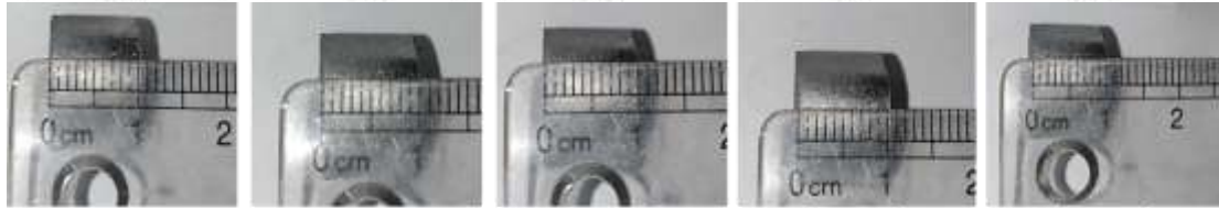
Green body material komposit berpori space holder karet
