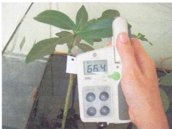
Gambar 13. pengukuran kadar klorofil daun mangrove menggunakan klorofilmeter
