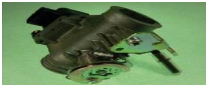
Gambar 2.11 Kontruksi throttle body
