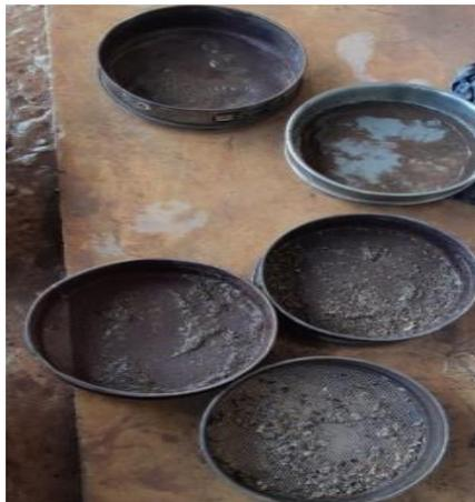
Gambar 3.6. Pengujian analisa butiran tanah
