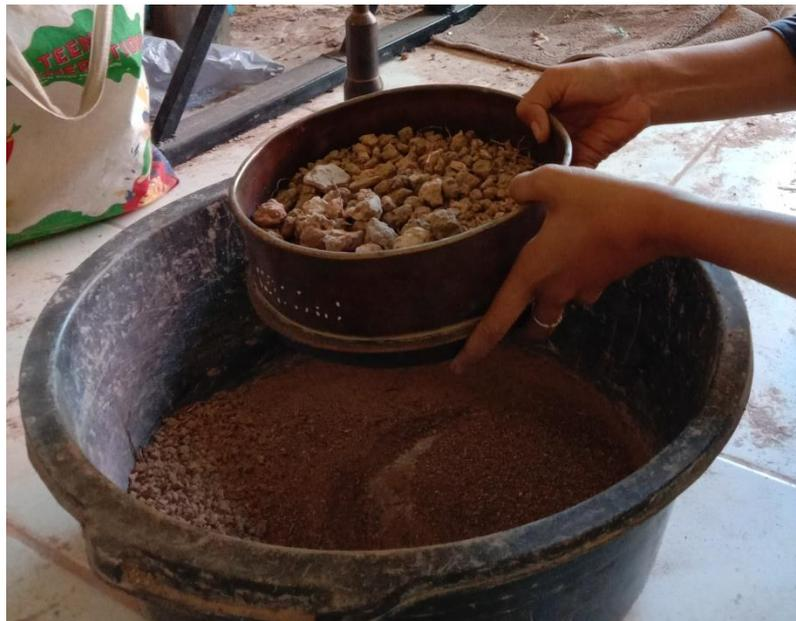
Gambar A.6. Proses penyaringan sampel tanah dengan saringan No.04
