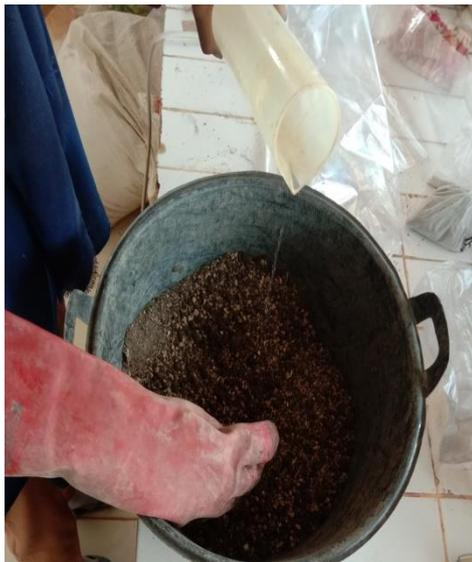
Gambar A.13. Pencampuran sampel Tanah dengan air
