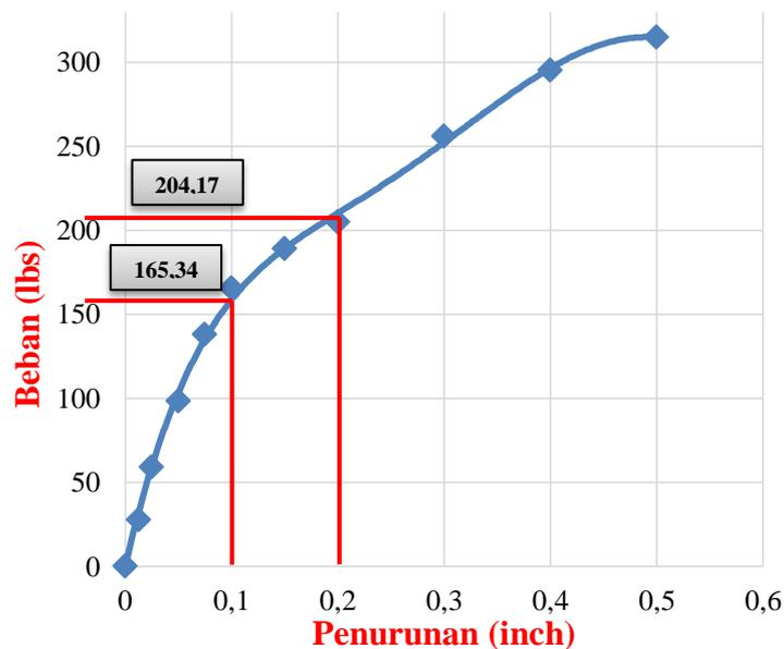
Gambar 4.6. Grafik pengujian CBR *soaked* tanah asli
