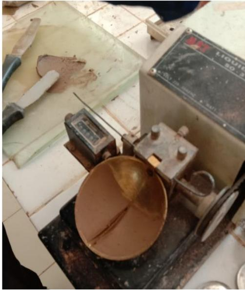
Gambar A.11. Pengujian batas cair
