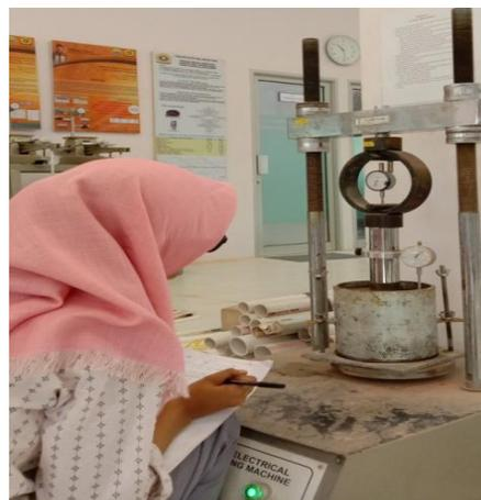
Gambar 3.19. Pengujian CBR *soaked* dengan campuran
