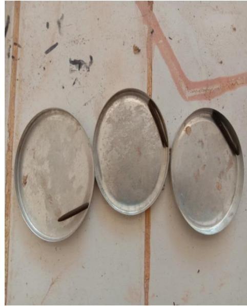
Gambar A.12. pengujian batas plastis
