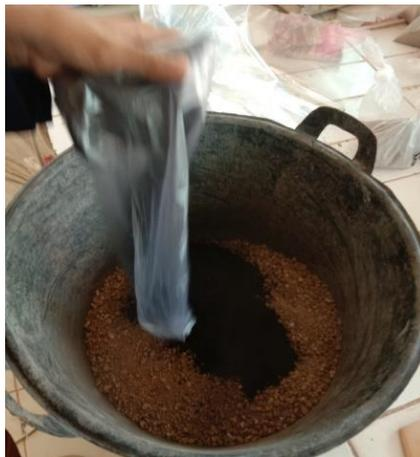
Gambar 3.12. Pencampuran dengan abu limbah pabrik kertas
