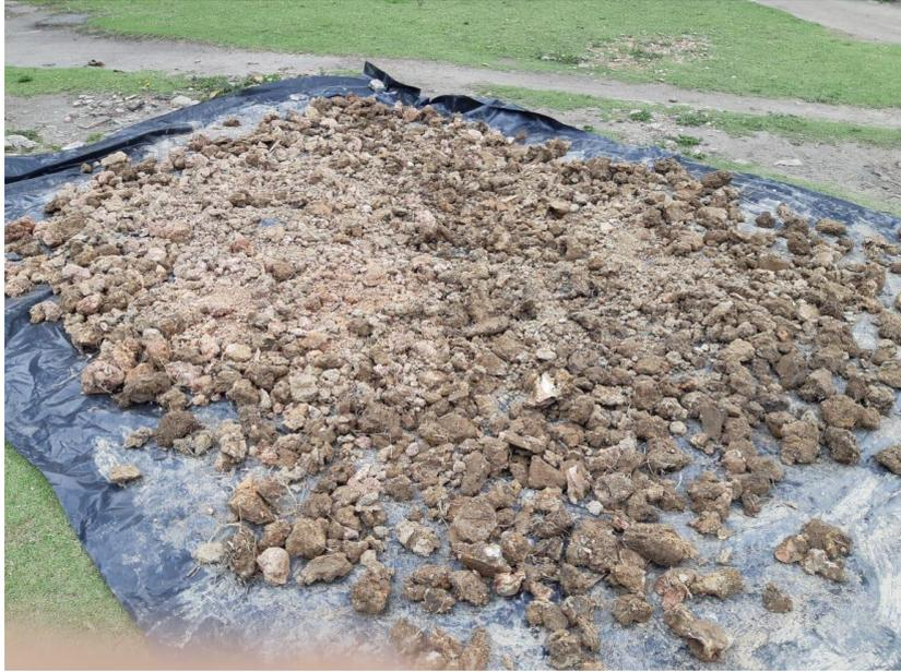
Gambar A.3. Proses pengeringan sampel tanah di bawah sinar matahari
