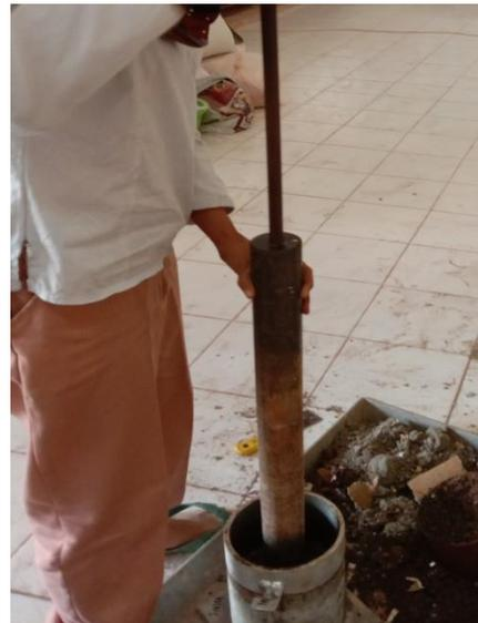
Gambar A.14. Pemadatan Tanah dengan Cetakan CBR
