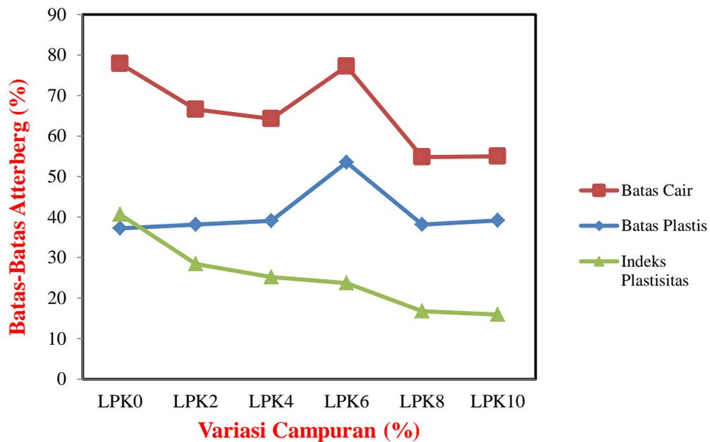
Gambar 4.7. Grafik pengujian batas-batas atterberg dengan campuran
