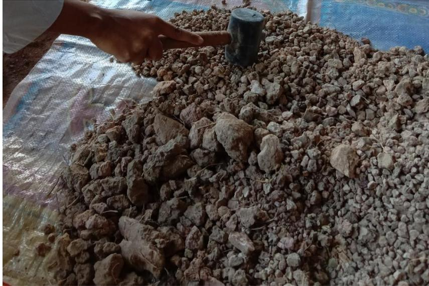
Gambar A.5. Penghancuran sampel tanah menggunakan palu karet
