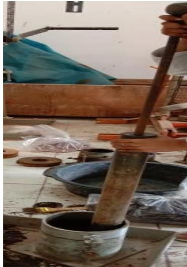
Gambar 3.16. Pemadatan tanah standar dalam cetakan CBR
