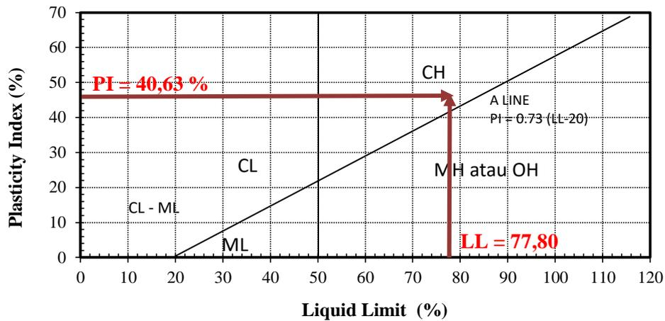
Gambar 4.3. Grafik klasifikasi tanah sistem USCS
