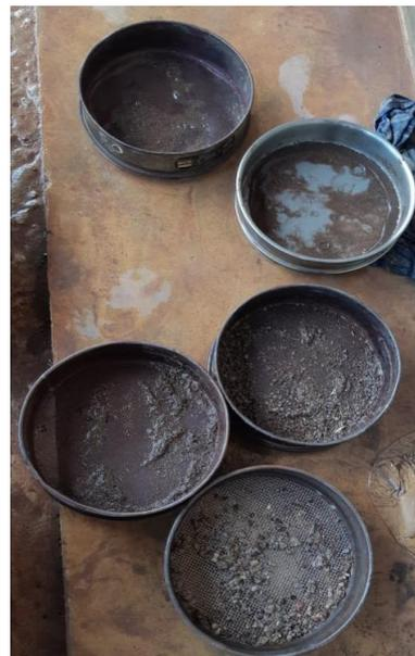
Gambar A.10. Pengujian analisa saringan
