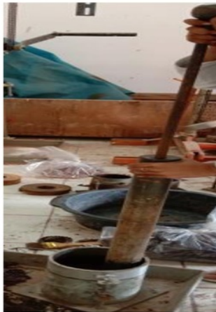
Gambar 3.16. Pemadatan tanah standar dalam cetakan CBR
