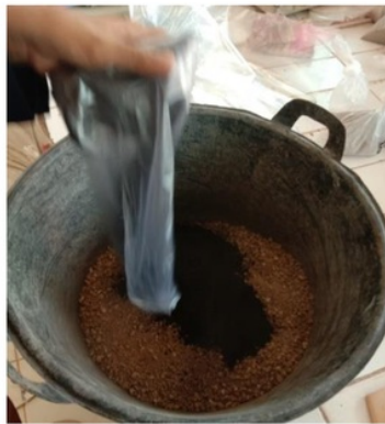
Gambar 3.12. Pencampuran dengan abu limbah pabrik kertas
