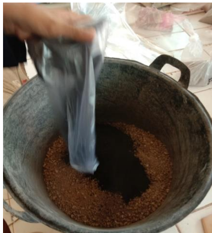
Gambar 3.12. Pencampuran dengan abu limbah pabrik kertas
