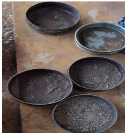
Gambar 3.6. Pengujian analisa butiran tanah
