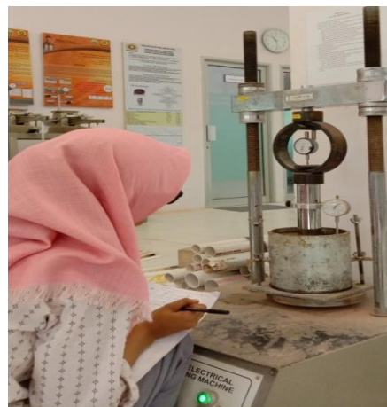
Gambar 3.19. Pengujian CBR soaked dengan campuran
