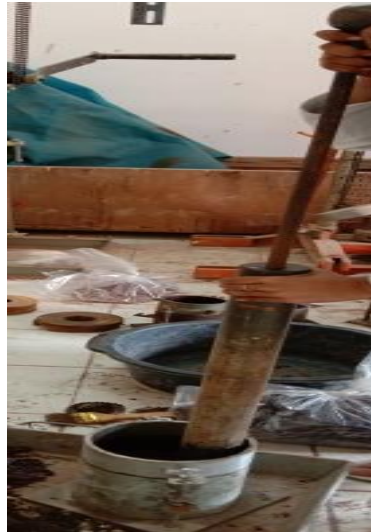
Gambar 3.16. Pemadatan tanah standar dalam cetakan CBR
