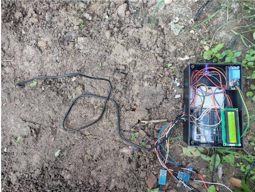
**Gambar 4.4 Tampak Atas Posisi Sensor DS18B20**
