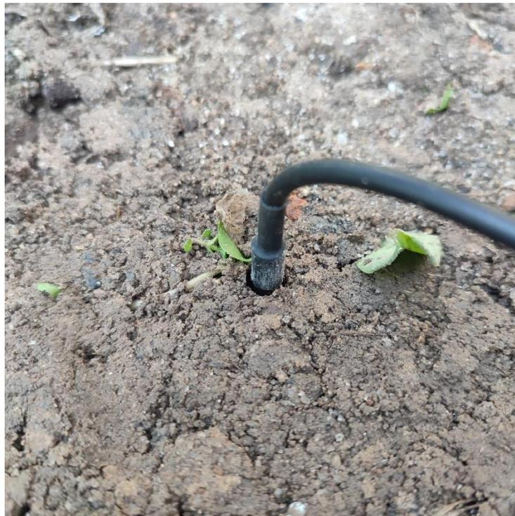
**Gambar 4.3 Penempatan Sensor DS18b20**
