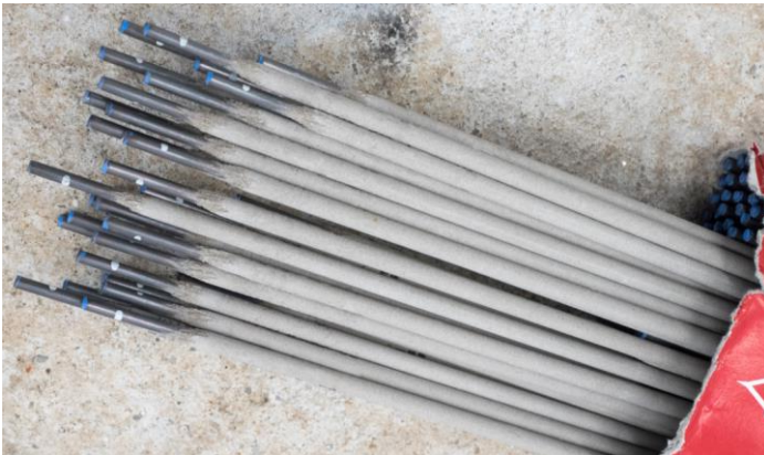
Gambar 36. Filler metal yang biasa digunakan pada proses pengelasan
